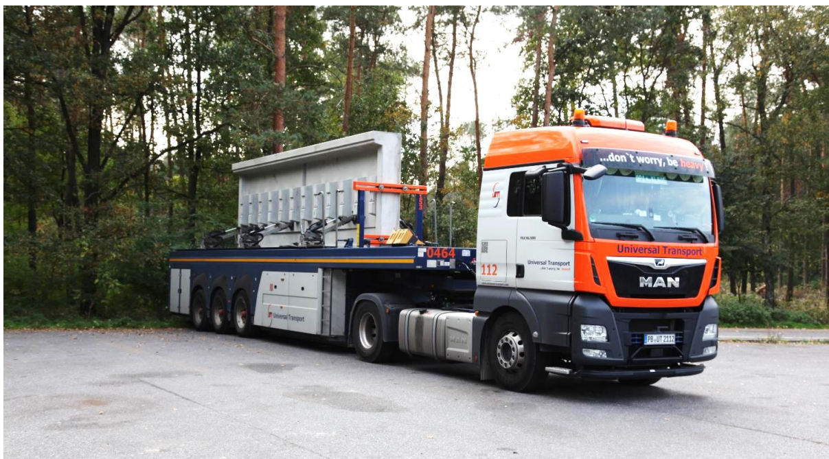
Pojazd do transportu prefabrykatów GTW typu innenlader.
